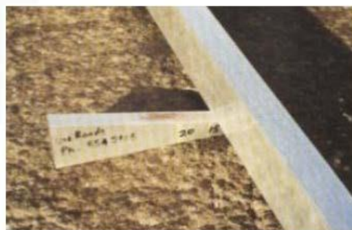
Figura 789 - 2. Cuña graduada como elemento para medir la profundidad del ahuellamiento
